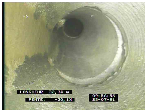
4-1-19A, 00:18:38, 32.74m Assemblage déplacé de 12 h. à 12 h.
