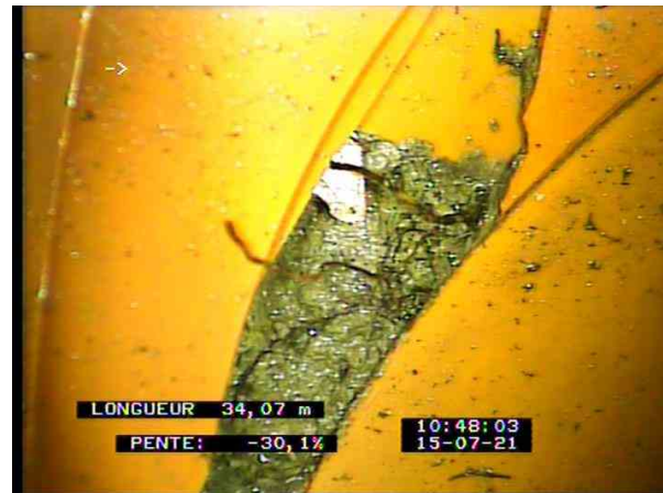
1-1-9A, 00:14:17, 34.07m Sol visible par le défaut
